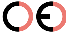
Falsche CE-Kennzeichnung (zu großer Zwischenraum)
