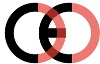
Falsche CE-Kennzeichnung (zu dicht)
